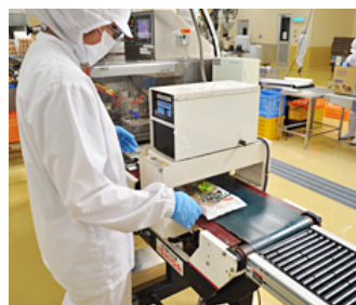
金属検出機の作動確認
